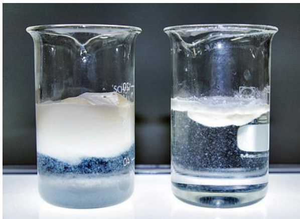
Quellverhalten von Deuteron VT 819 (links) und Deuteron XG (rechts).
